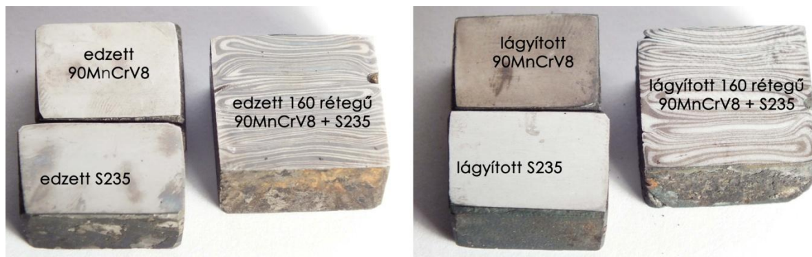
1. Ábra: A diffúziós jelenségek vizsgálatára készített próbatestek metallográfiai csiszolatai
